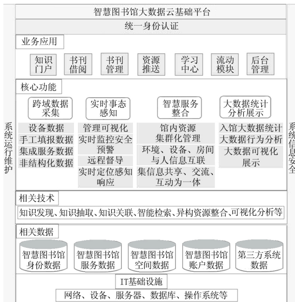
图1 智慧图书馆系统总体构架
